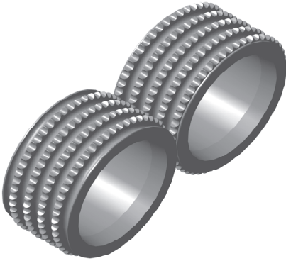
элементов зубчато-желобчатой конфигурации (рис.1): F1 с размерами 62,6×60,0×27,0мм и F2 с размерами 39,8×36,0×17,5мм, применяемых на прессах, разработанных в Институте черной металлургии. Влияние свойств шихты показано на примере двух шихт, отличающихся между собой по физико-механическим свойствам, одна из них – на основе отсевов силикомарганца (фр. –6мм), другая – на основе коксовой мелочи (фр. –6мм). Рис.1 Бандажи с зубчато-желобчатой конфигурацией формующих элементов
