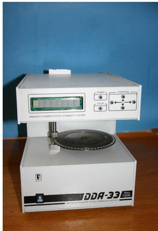
*Рис. 1. Общий вид прибора ДДА-33МП для определения статической прочности при сжатии порошков алмаза*
