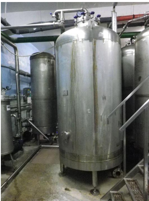
Рисунок 3 – Внешний вид насыпного угольного фильтра
