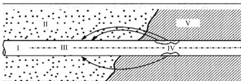
Рис. 1. Схема корозії підземного трубопроводу в умовах різної аерації ґрунту: I – труба; II – пісок; III – катодна зона; IV – анодна зона; V – глина.
