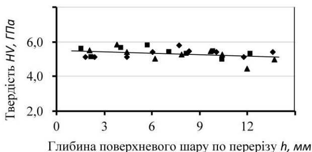
Рис. 5. Розподіл мікротвердості по перерізу зразка ВНЗ Ø32 мм вмістом вольфраму 90% після спікання, відпалу та гвинтової екструзії: ◆ ряд I, ■ ряд II, ▲ ряд III
