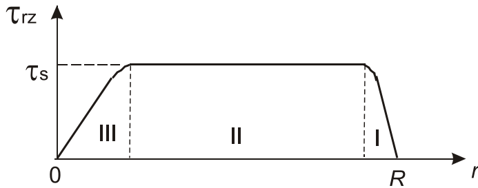
Рис. 1. Схематическое распределение касательного напряжения по радиусу диска
