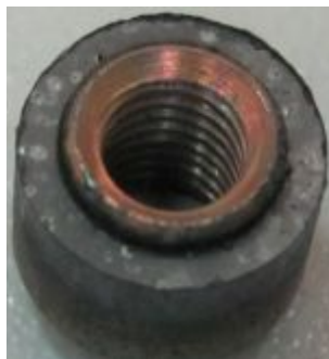
Рис. 2. Общий вид перлины после прессования
