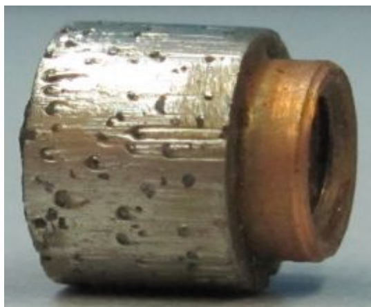
Рис. 9. Общий вид перлины после работы в канатной пиле
