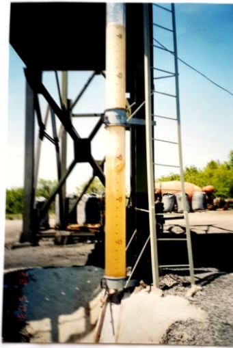
Рисунок 2 - Стенд для исследований способов формирования различных конструкций скважинных зарядов ВВ
