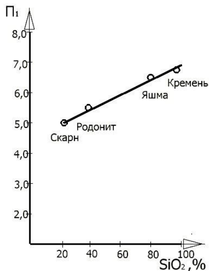
Рис. 1. Зависимость твердости по Моосу ( P_i ) некоторых видов минералов и горных пород в зависимости от наличия в их составе оксида кремния.
