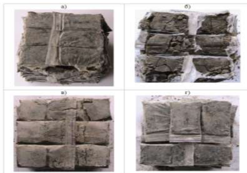
а – без имитации рельефа пород; б, в, г – с имитацией рельефа (б – крайние со стороны кровли и почвы слои ПП; в – вторые, а в кровле иногда и третьи слои; г – средние слои)
