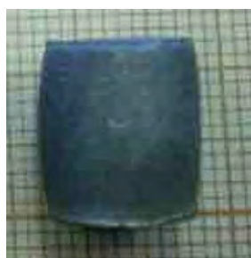
Рис. 2. Зовнішній вигляд зразків твердого сплаву VN20, кінцево спечених у вакуумі під впливом одноосьового тиску 0,6 МПа за температури 1400 °С з тривалістю витримування 30 хв: а – попередньо випалено каучук у метановодневому середовищі при температурі 1000 °С (партія 4); б – попередньо випалено каучук у метановодневому середовищі при температурі 1000 °С, проведено нормалізуюче спікання у метановодневому середовищі за температури 1100 °С та попереднє спікання у метановодневому середовищі за температури 1200 °С (партія 5); в – попередньо випалено каучук у метановодневому середовищі за температури 1000 °С, проведено нормалізуюче спікання у метановодневому середовищі за температури 1100 °С, попереднє спікання у метановодневому середовищі за температури 1200 °С та повторне попереднє спікання у вакуумі за температури 1400 °С (партія 6)
