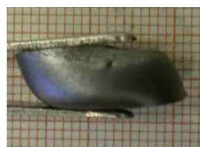
Рис. 2. Зовнішній вигляд зразків твердого сплаву VN20, кінцево спечених у вакуумі під впливом одноосьового тиску 0,6 МПа за температури 1400 °С з тривалістю витримування 30 хв: а – попередньо випалено каучук у метановодневому середовищі при температурі 1000 °С (партія 4); б – попередньо випалено каучук у метановодневому середовищі при температурі 1000 °С, проведено нормалізуюче спікання у метановодневому середовищі за температури 1100 °С та попереднє спікання у метановодневому середовищі за температури 1200 °С (партія 5); в – попередньо випалено каучук у метановодневому середовищі за температури 1000 °С, проведено нормалізуюче спікання у метановодневому середовищі за температури 1100 °С, попереднє спікання у метановодневому середовищі за температури 1200 °С та повторне попереднє спікання у вакуумі за температури 1400 °С (партія 6)
