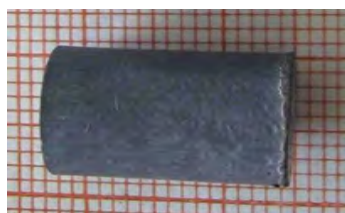
Рис. 1. Типовий зовнішній вигляд зразка твердого сплаву VN20, вільно кінцево спеченого в вакуумі після випалювання каучуку (партія 1), попереднього спікання у метановодневому середовищі (партія 2) і повторного попереднього спікання у середовищі вакууму (партія 3)
