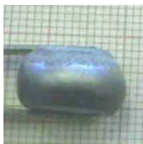
Рис. 2. Зовнішній вигляд зразків твердого сплаву VN20, кінцево спечених у вакуумі під впливом одноосьового тиску 0,6 МПа за температури 1400 °С з тривалістю витримування 30 хв: а – попередньо випалено каучук у метановодневому середовищі при температурі 1000 °С (партія 4); б – попередньо випалено каучук у метановодневому середовищі при температурі 1000 °С, проведено нормалізуюче спікання у метановодневому середовищі за температури 1100 °С та попереднє спікання у метановодневому середовищі за температури 1200 °С (партія 5); в – попередньо випалено каучук у метановодневому середовищі за температури 1000 °С, проведено нормалізуюче спікання у метановодневому середовищі за температури 1100 °С, попереднє спікання у метановодневому середовищі за температури 1200 °С та повторне попереднє спікання у вакуумі за температури 1400 °С (партія 6)
