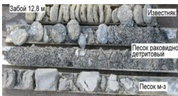
Рис. 5. Общий вид образцов керна при изысканиях под площадки постановки СПБУ «Петр Годованец», Черное море (Украина)
