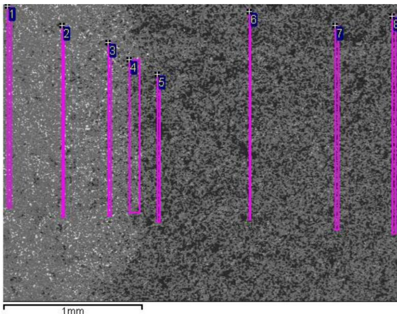
Электронное изображение микроструктуры границы раздела между поверхностным слоем образца и основным материалом  $\text{SiC-7B}_4\text{C-15TiC}$ , полученным горячим прессованием при давлении 25 МПа и температуре 2080 °С с последующим силицированием.
