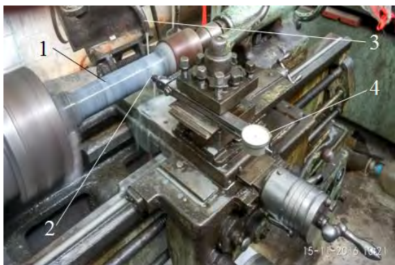
Рис. 1. Загальний вигляд спеціального стенда для досліджень: 1 – циліндричний блок пісковика Торезького родовища, 2 – циліндричний породоруйнівний елемент, 3 – система охолодження породоруйнівного елемента, 4 – динамометричний пристрій
