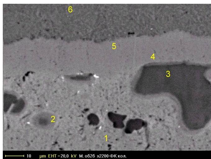
Рис. 4. Структура переходного слоя ( $Ti-Cu$ ) –  $Ni-Fe$ .
