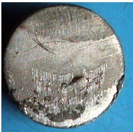
Рис. 3. Вид подложки после испытаний на срез напеченного титанового слоя.
