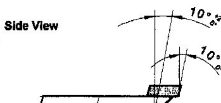
Рис. 1. Требования к токарному инструменту из природного алмаза.
