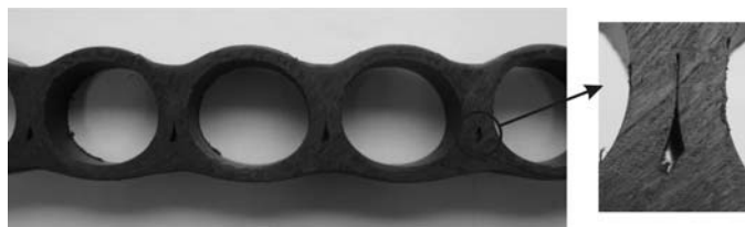
Рис. 1. Типовий тріщиноподібний дефект-непровар у стінці стільника.
