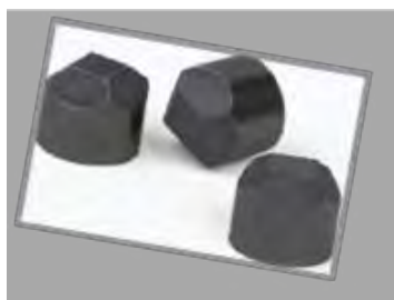
Рис. 4. Загальний вигляд пуансонів кубічного АВТ, виготовлених з композиту Versimax composites [14]
