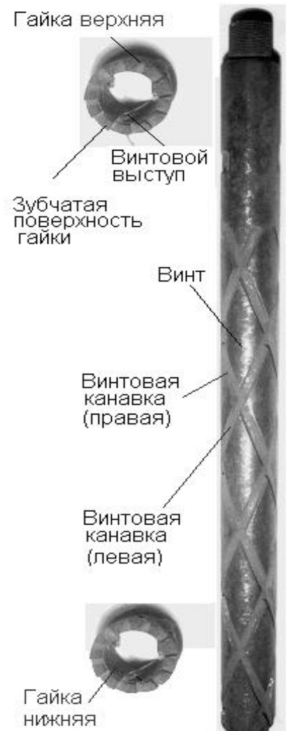
Рис. 2. Винтовая пара поршневого гидробура.
