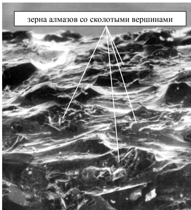
Рис. 1. Вид участка рабочей поверхности импрегнированной коронки со сколотыми вершинами алмазных зерен.
