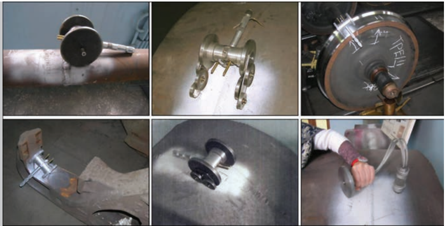
Устройства для разнонаправленного подвижного локального намагничивания металлоконструкций при поиске в них трещин
