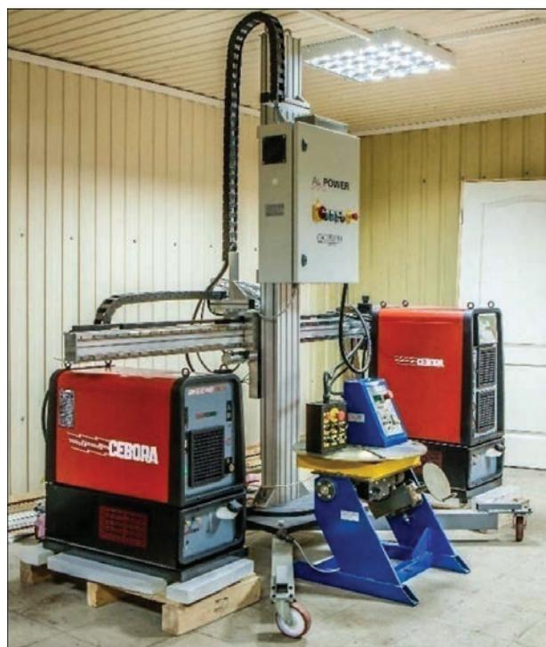
Инновационное универсальное оборудование для плазменной, гибридной и комбинированной (тандем) «Плазма-МИГ» сварки, разработанное в ИЭС им. Е. О. Патона и поставленное на лабораторно-технологическую базу КУИС в г. Гуанчжоу, КНР
