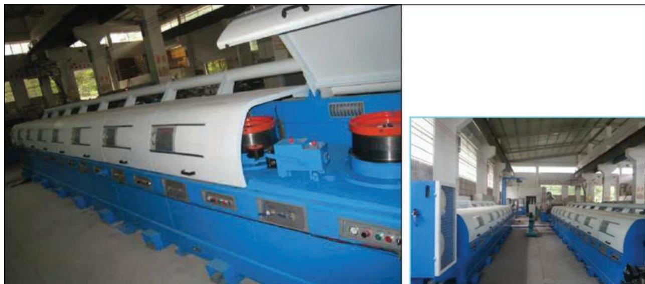
Линия для получения порошковых проволок для дуговой сварки, наплавки и термического напыления на лабораторно-технологической базе КУИС в г. Гуанчжоу, КНР
