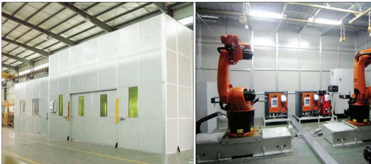
Участок лазерной сварки и резки, а также гибридной лазерной сварки двумя роботами с лазером 10 кВт на лабораторно-технологической базе КУИС в г. Гуанчжоу, КНР (лазерная сварка глубоким проплавлением, гибридная лазер-МИГ сварка, лазерная сварка сканированием, лазерная сварка двумя лучами, 3D лазерная резка)
