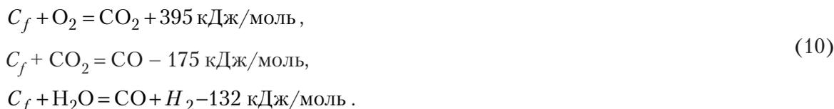
В определенных условиях можно считать, что газ является смесью, состоящей из семи компонентов,  $O_2$ ,  $C$ ,  $O$ ,  $CO_2$ ,  $H_2$ ,  $H_2O$ ,  $N_2$ . Тогда в соответствии с приведенным перечнем реакций для определения скоростей исчезновения и образования компонент на единице поверхности частицы  $\dot{K}_k$  можно записать следующие соотношения:
