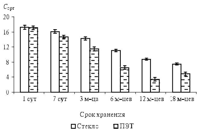
*Изменение концентрации органического углерода ( $C_{опр}$ ) в фасованной минеральной воде типа "Нафтуся" при ее хранении.*
