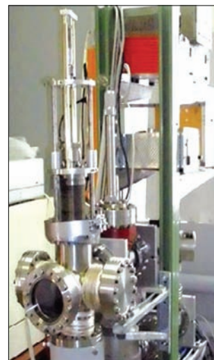
Рис. 4. Експериментальна установка в Інституті прикладної фізики НАН України для дослідження матеріалів прискорювальних структур на вакуумній пробій
