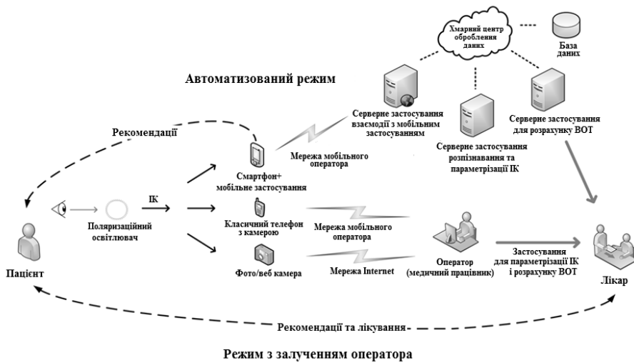
Рис. 10. Структура телемедичної системи моніторингу рівня VOT з використанням технології аналізу ІК
