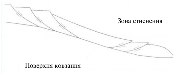
Рисунок 3 – Схема розташування зон розтягування, плоскопаралельного переміщення і стиснення в зсувному масиві [49]
