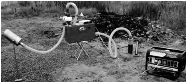
Рис.1. Мобильная аппаратура для исследования скважин биогаза.
