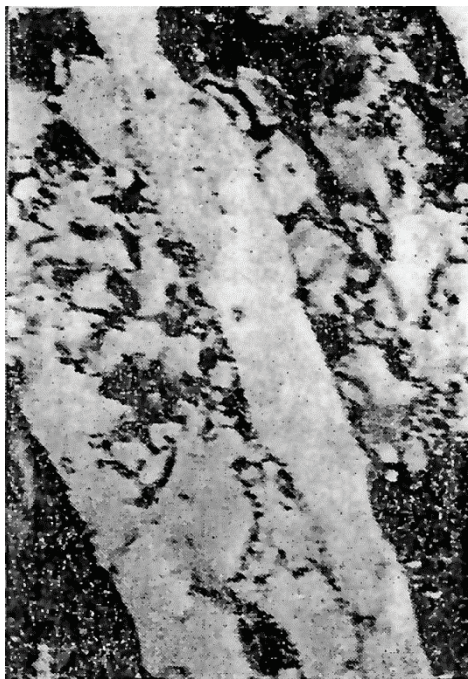
Рис. 1. Тонкая структура металла МТО трубы после 51382 часов эксплуатации на КПП в/д. Увеличение \times 30000 .
