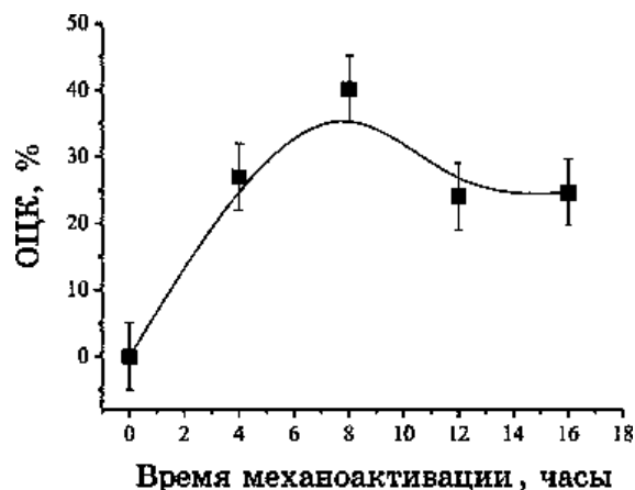
Рис. 3. Изменение концентрации \alpha -фазы (мартенсита) от времени механоактивации инварного сплава Fe-30,9% Ni-1,23% C в планетарной мельнице. 4
