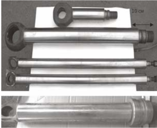
Рис. 3. Відновлена поверхня штоків гідроциліндрів шахтного кріплення (обладнання гірничодобувної галузі) методом електродугового напилення покриттів із порошкових дротів з наступним шліфуванням: довжина штоків 600–1000 мм, діаметр штоків 40–100 мм
