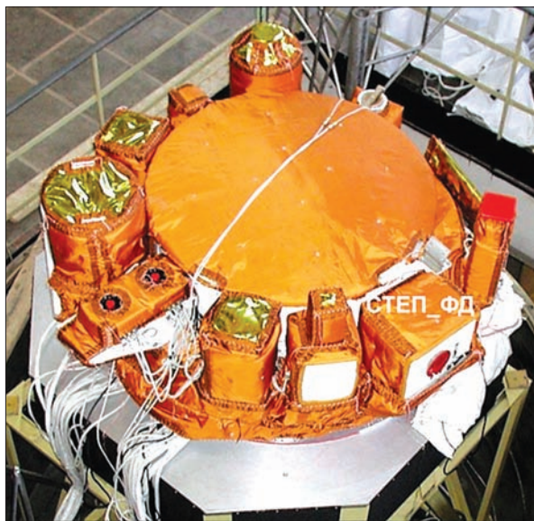
Рис. 5. Блок детекторів STEP-ФД технологічного зразка приладу STEP-Ф у складі зовнішніх блоків детектування комплексу наукової апаратури «Фотон»
