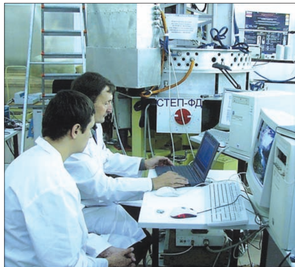
Рис. 7. Стикувальні випробування технологічного зразка приладу СТЕП-Ф на імітаторі космічного апарата в Інституті астрофізики Московського інженерно-фізичного інституту
