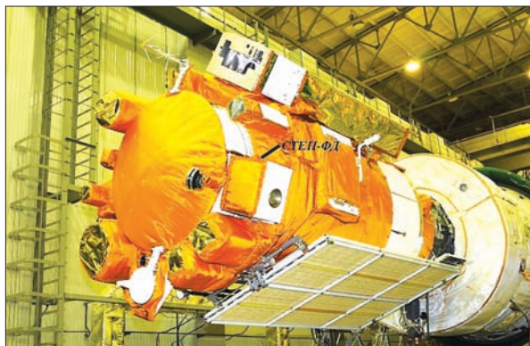
Рис. 8. Космічний комплекс «КОРОНАС-Фотон» перед накатуванням обтічника в монтажно-випробувальному корпусі космодрому «Плесецьк». На передньому плані космічного апарата — зовнішній блок детекторів СТЕП-ФД приладу СТЕП-Ф
