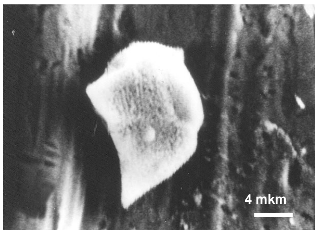
Рис. 3. Частица оксида урана, обнаруженная на фильтре АФА РСП-20 (отбор пробы аэрозоля на фильтр).
