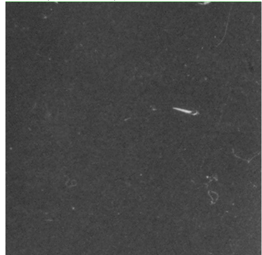
Рис. 16. Фрагмент автордиограммы фонового участка пленки, полученный при проведении автордиографии 2-го фильтра АФА импактора (5-й каскад). Увеличение 3х.
