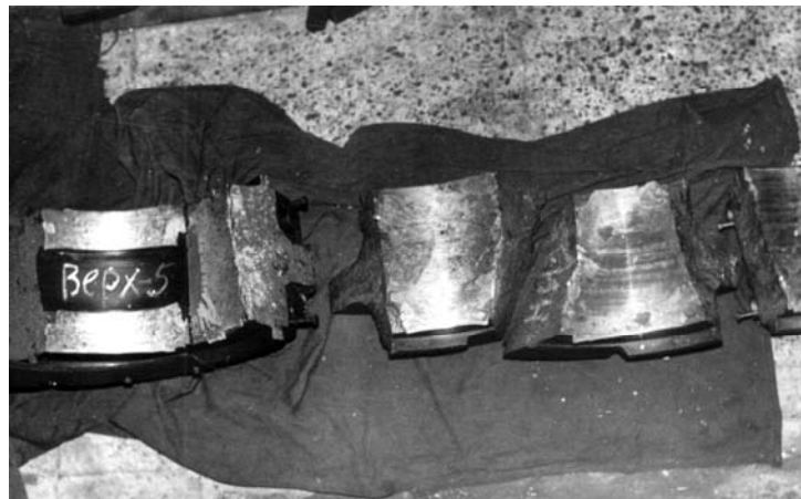
Рис. 9. Подшипник турбины со стороны генератора.
