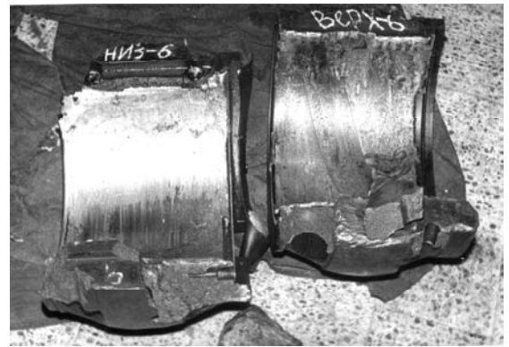
Рис. 8. Подшипник генератора со стороны турбины.
