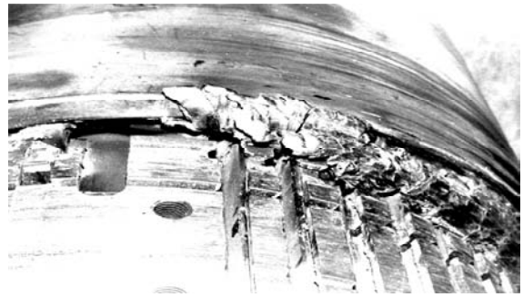
Рис. 6. Остатки обмотки загнуты на бандажное кольцо (статора контактных колец).
