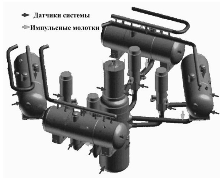
Рис. 3. Размещение датчиков системы обнаружения свободных предметов на основном оборудовании первого контура РУ ВВЭР-1000 (В-320).
