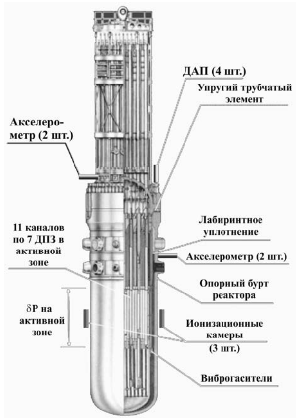
Рис. 2. Расположение детекторов системы виброшумовой диагностики.
