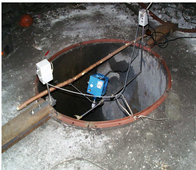
Рис. 2. Размещение воздуходувки в «Байпасе».
