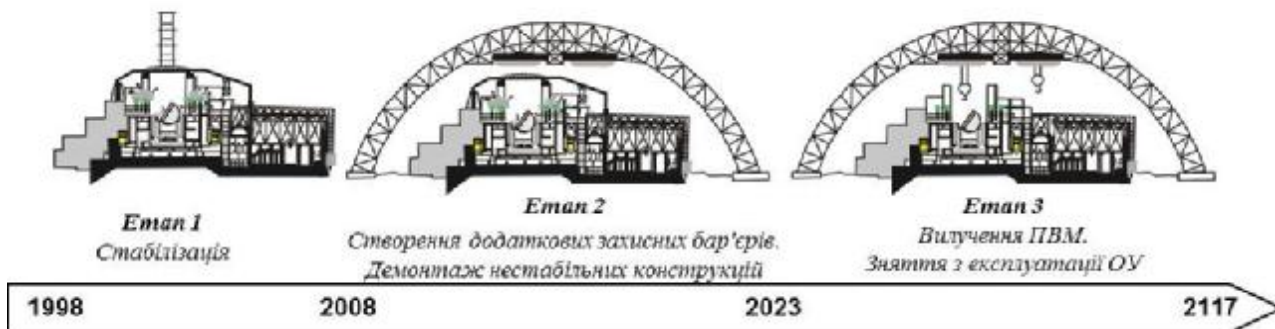
Перетворення об'єкта «Укриття» на ЕБС.
