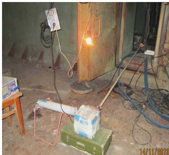
Рис. 5. Расположение воздуходувки, радоновой станции СРС-05 и прибора «Альфарад плюс А» в помещении 210/8 при отборе аэрозолей из помещения 210/7 в южной части ПРК.
