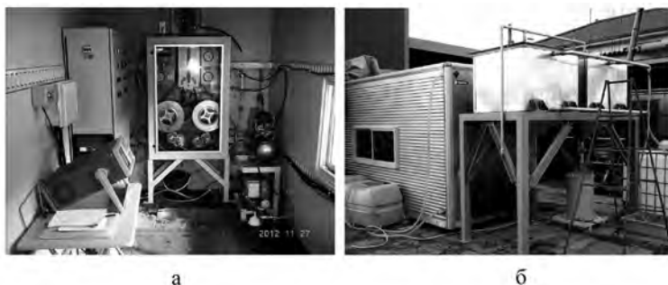
Рис.5.Пилотная передвижная установка плазменнодуговой очистки воды (а) и транспортный модуль (б).
