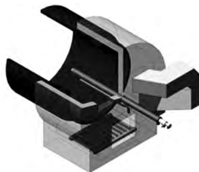
Рис.2. Установка горелки ГУРФ-30 совместно с ЗЗУ на печи № 1.
