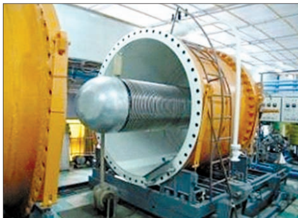
Рис. 6. Електростатичний (3-пучковий) прискорювач із зовнішнім інжектором
