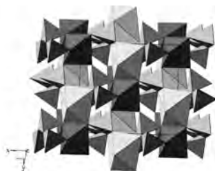
Рис.1. Структура диоксида, по [7] (моноклинный, пространственная группа (пр. гр.) C2/c ; a = 0,9750 нм; b = 0,8926 нм; c = 0,5251 нм; \beta = 105,90^\circ ).
