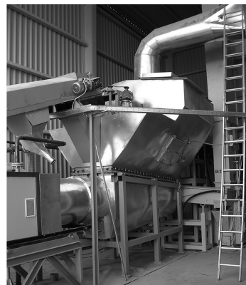
Рис.5. Сушилка песка в составе линии по производству сухих строительных смесей.
