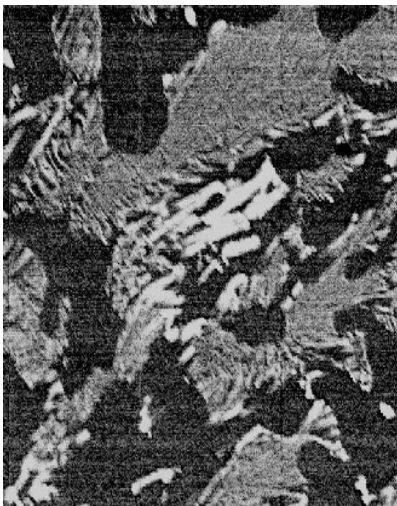
Рис. 3. Включения Al_3Ni (режим отраженных электронов), х1000
