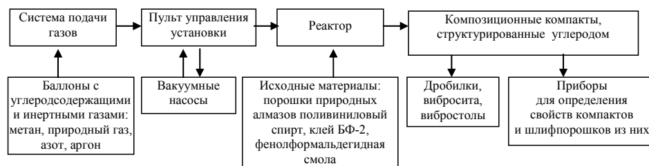
Рис. 2. Схема цепи аппаратов и систем для получения компактов из НППА, аппаратов для изготовления шлифпорошков и приборов для определения свойств изготовленных шлифпорошков.
