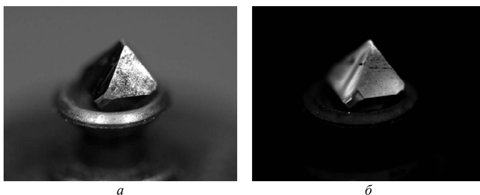
Рис. 1. Изображение кристалла октаэдрического габитуса ( a ), полученного при относительно высоких температурах, и картина его фотолюминесцентного свечения ( б ).
