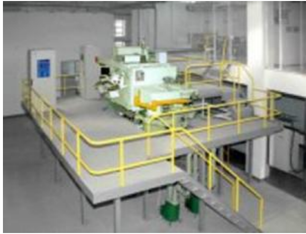
Рис. 1. Зовнішній вигляд промислової електронно-променевої установки Л5 для одержання парофазних конденсатів на основі міді та металів VIa групи.
