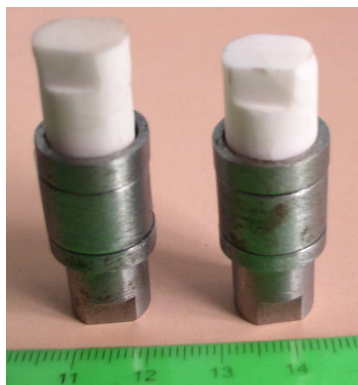
Рис. 4. Паяное и сваренные давлением адгезионно-механические соединения керамики с металлом
