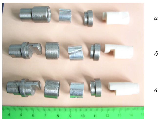
Рис. 2. Подборка деталей для сварки давлением разных конструкций металлокерамического сочленения: а — круглый шип-отверстие; б, в — сочленение фигурных полукруглых и обычных полукруглых торцов соответственно
