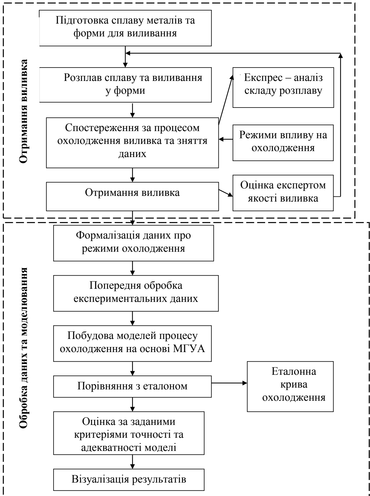
Рис. Схема технології розв'язання задач моніторингу процесів ливарного виробництва на основі МГУА
