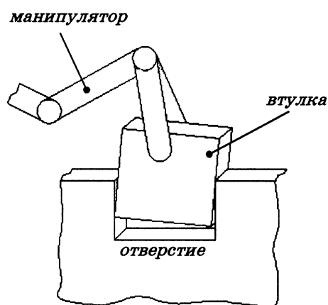
Рис. 1. Вставка втулки в отверстие при помощи манипулятора.
